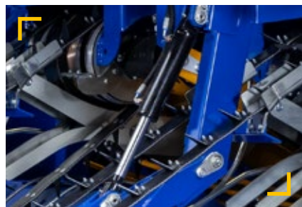
Hydraulisch heffen van de afleg
