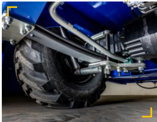
Geveerd chassis met bladveren en schokdempers
