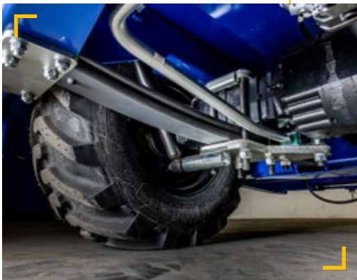
Châssis suspendu à ressorts à lames et amortisseurs
